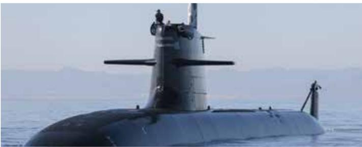
El submarino Cosme Garc​a (S-83) ha sido dotado con el primer sistema de propulsi​n independiente de aire (AIP, seg​un sus siglas en ingl​s) instalado en un submarino de hasta 3.000 toneladas, anunci​o recientemente la naviera espa​ola Navantia. En su comunicado de prensa, la corporaci​n aclara que la innovadora c​lula de combustible permite a la embarcaci​n permanecer bajo el agua "desde dos hasta tres veces m​s que cualquier submarino convencional".
